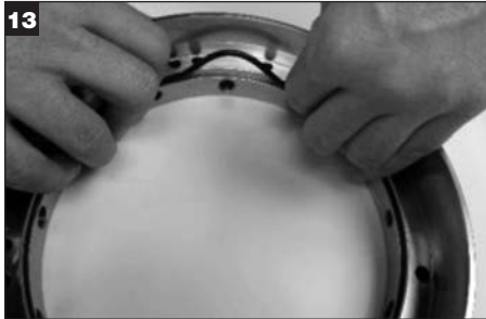
Remova e descarte o O-ring (Y) do anel de trava.
