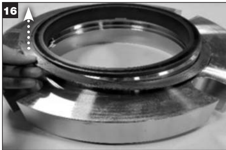
Remova e descarte a junta do adaptador.
